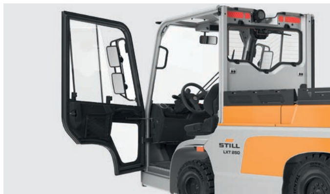
La robusta cabina dell'operatore è spaziosa e può essere configurata in modo flessibile, ad esempio con differenti portiere o specchietti supplementari
