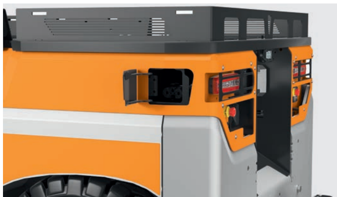
Ricarica sicura e veloce senza necessità di aprire l'anta del vano batteria grazie allo sportello di ricarica rapida opzionale
