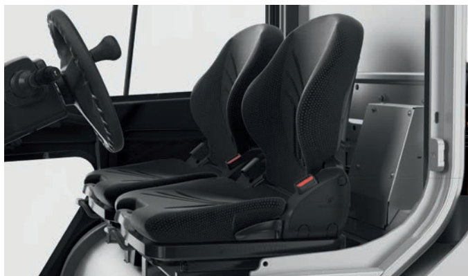
Comfort di lavoro unico nel suo genere, con sedile a sospensione pneumatica MSG 75 opzionale: sospensione eccellente su telaio ammortizzato e molleggiato
