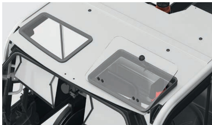
Il finestrino sul tettuccio (opzionale) offre una visuale libera verso l'alto e un'ulteriore ventilazione
